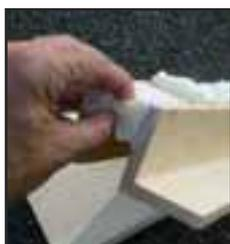
Réticulé la mousse devient semi-rigide.
